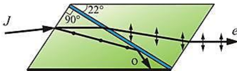
Рис. 2.56. Прохождение лучей через поляризатор (призма Николя)
