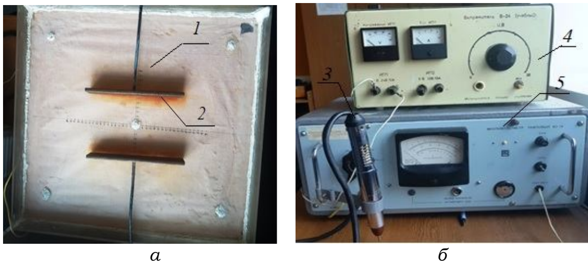
Рис. 2.14: а – электролитическая ванна с электродами; б – милливольтметр ламповый ВЗ-14 с зондом и выпрямитель ВС-24
